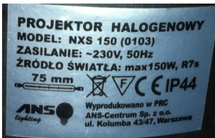
Rysunek 6-9 Tabliczka znamionowa jednej z dwóch lamp halogenowych wykorzystanych w eksperymencie.
