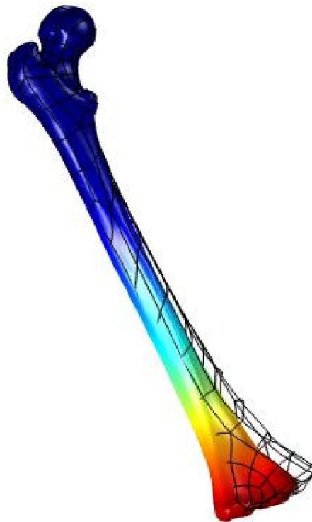
Rys. 16 Czarną siatką zaznaczone przemieszczenie
