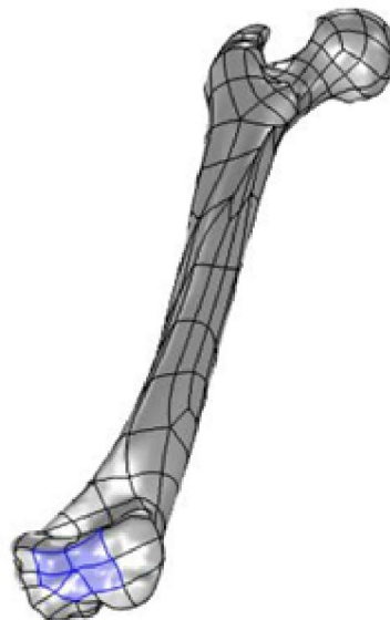
Rys.9 Model kości z zaznaczoną kolorem fioletowym powierzchnią przyłożenia siły
