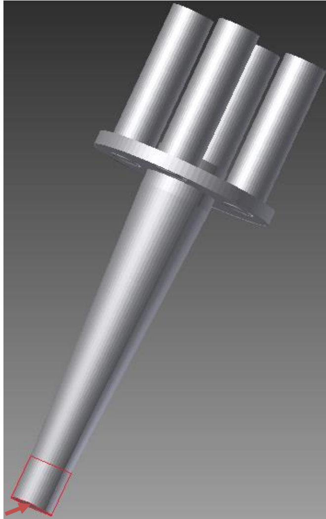
Rysunek 9. Geometria z oznaczeniem miejsca utwierdzenia
