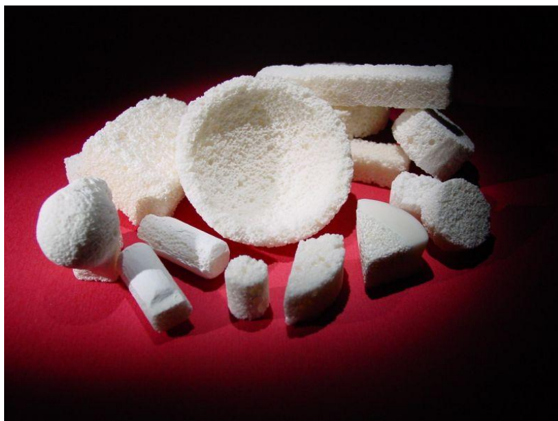
Rys.3. Porowate implanty korundowe o różnorodnych kształtach i wymiarach[18].
