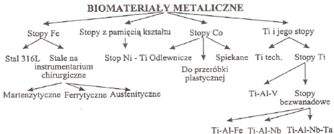
Rys.4. Podział obecnie stosowanych biomateriałów metalicznych [4].
