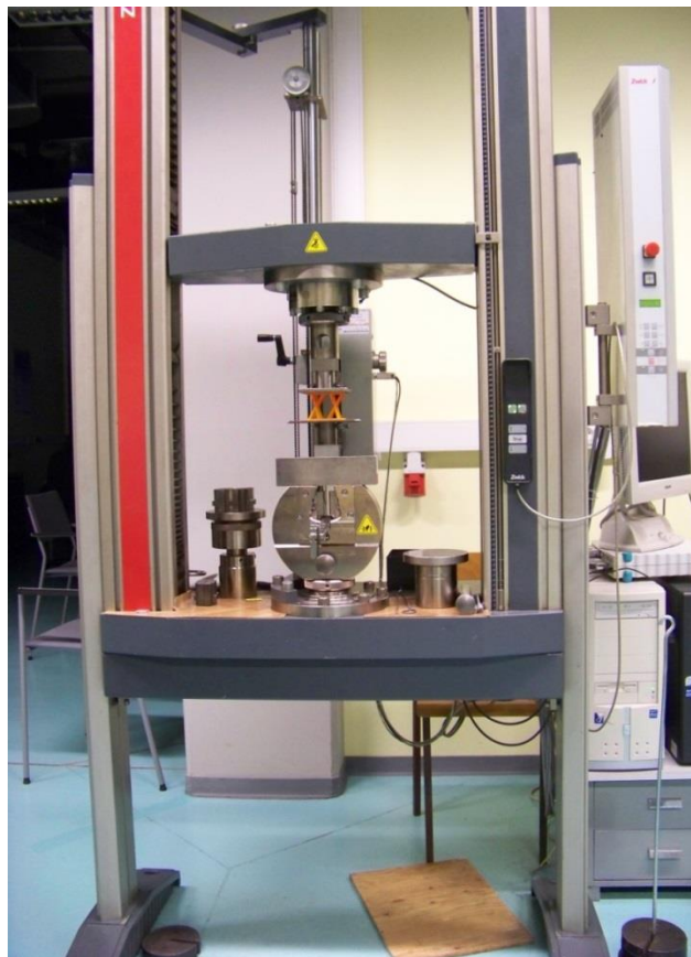
Rysunek 40. Maszyna wytrzymałościowa z zamontowaną próbką
