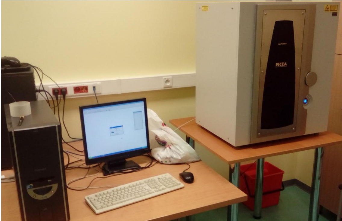
Fot. 24 Stanowisko do skanowania 3D metoda triangulacyjną Politechniki Poznańskiej.
