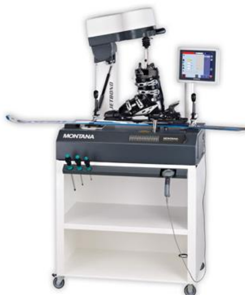
Fot. 8 Maszyna do automatycznego pomiaru siły wypięcia [26].
