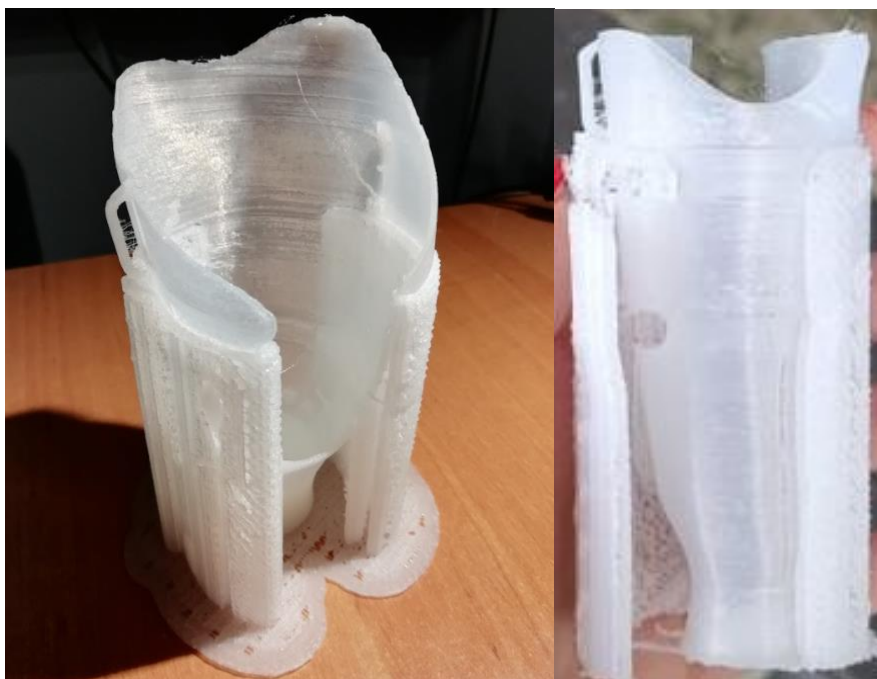
Fot.14.3. Wydrukowane leje protezowe z materiału PA12 posiadające brim i podpory (od lewej: dla kota i dla psa).
