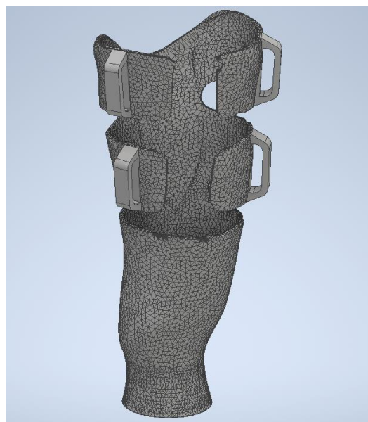
Rys.9.2. Lej protezowy dla psa - model w środowisku Autodesk Inventor Professional 2021 .
