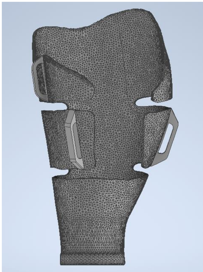
Rys.9.8. Lej protezowy dla kota - model w środowisku Autodesk Inventor Professional 2021 .
