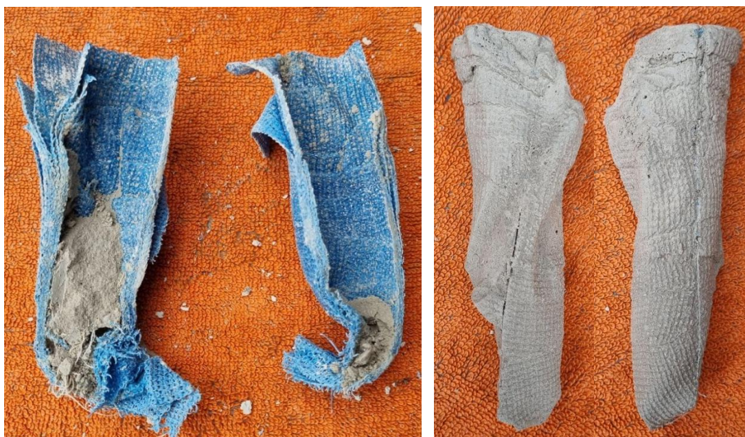
Fot.6.2. Kolejno od lewej: rozcięty negatyw z pozostałymi fragmentami pozytywu gipsowego, wyciągnięty z formy uszkodzony pozytyw.
