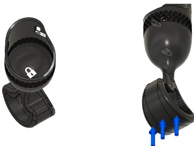
Rys. 7.3 Zadane stałe utwierdzenie i obciążenie dla obu przypadków.
