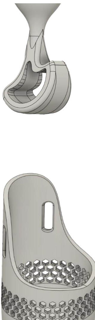
Rys. 7.2 Uproszczony model protezy. Od góry: brak pokrycia antypoślizgowego, brak zaokrąglenia brzegu leja. Widok w programie Fusion 360.
