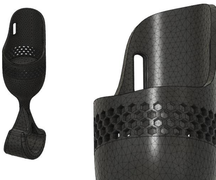
Rys. 7.4 Wygenerowana siatka elementów skończonych dla obu przypadków.
