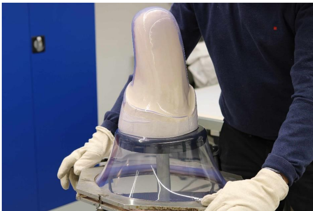
Rys. 4.1 Etap naciągania tworzywa termoformowalnego na pozytyw gipsowy [28].
