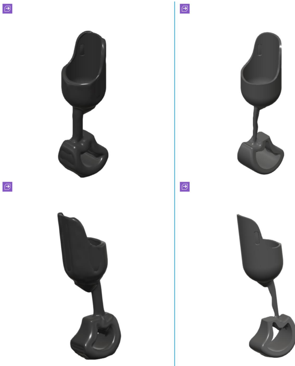
Rys. 8.3 Porównanie wyników badania zakładającego zachowanie całej stopy protezowej. Od lewej: model z materiału PA11, model z materiału PEKK.
