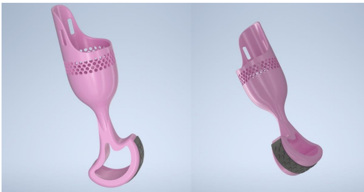
Rys. 6.11 Wyrenderowany w programie Autodesk Inventor Professional model protezy kończyny piersiowej kota. Widok ogólny.
