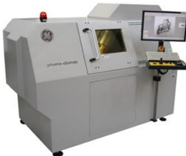
Rysunek 21. Zdjęcie tomografu phoenix v|tome|x s [35]
