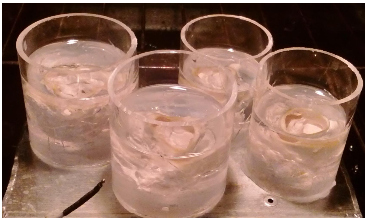
Rysunek 22. Próbki podczas procesu utwardzania w podwyższonej temperaturze. W dolnym lewym rogu widoczna jest termopara służąca do pomiaru temperatury.
