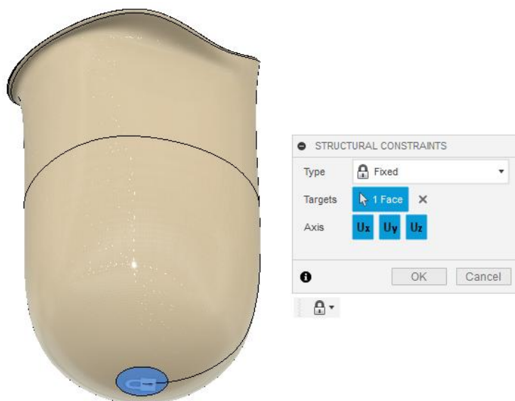
Rys 7.3 Wybrana płaszczyzna utwierdzenia modelu, zablokowanie ruchu względem osi U_x, U_y, U_z , widok od dołu w programie Fusion 360
