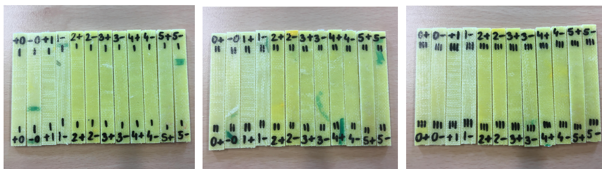
Rys 6.12 Próbki dla badania wytrzymałości na zginanie od lewej: seria I, seria II, seria III.
