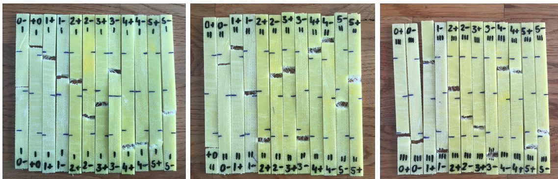
Rys 6.14 Zerwane próbki po badaniu wytrzymałości na rozciąganie, od lewej: seria I, seria II, seria III.
