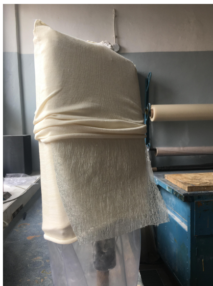
Rys 6.4 Proces ubierania modelu w naprzemienne warstwy dzianiny bawełnianej i maty szklanej
