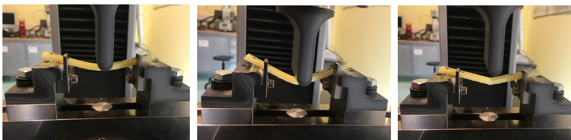
Rys 6.16 Przebieg badania: zachowanie próbki podczas zginania
