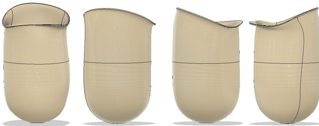
Rys 7.1 Zaprojektowana geometria leja protezowego uda; od lewej: strona wewnętrzna, strona zewnętrzna, widok z przodu, widok z tyłu
