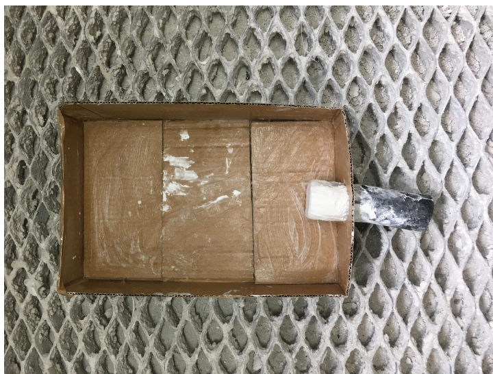
Rys 6.1 Kartonowa kształtka na model, zaizolowana za pomocą wazeliny, w celu późniejszego odjęcia od pozytywu
