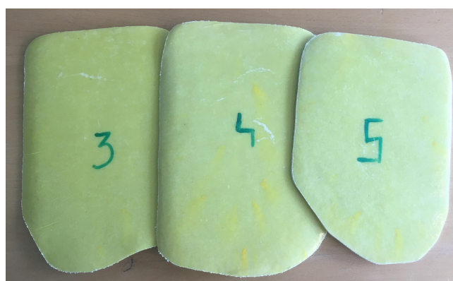
Rys 6.9 Gotowe płyty 3-5 po wycięciu i obróbce mechanicznej
