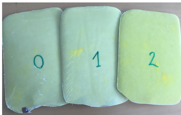
Rys 6.8 Gotowe płyty 0-2 po wycięciu i obróbce mechanicznej
