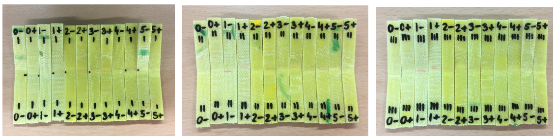
Rys 6.17 Wygląd próbek po próbie zginania, od lewej: seria I, seria II, seria III.
